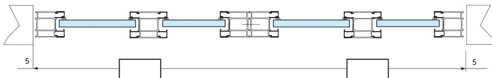
Telaio inferiore a "L" con telaio a "Z" su 3 lati     Telaio inferiore a "L" con telaio a "T" su 3 lati
