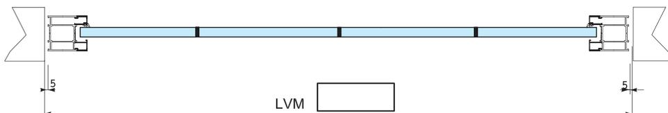
Telaio inferiore a "L" con telaio a "Z" su 3 lati     Telaio inferiore a "L" con telaio a "T" su 3 lati
