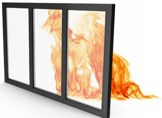
Le **vetrate fisse tagliafuoco VITREX F2 e VITREX F3** sono realizzate con un telaio portante in tubolare d'acciaio profilato zincato con uno spessore di 15/10, e sono rivestite da una copertura in estruso di alluminio trafilato in lega UNI 6060. All'interno, sono presenti lastre isolanti a base di calciosilicati che forniscono una protezione termica eccellente. La struttura ha uno spessore totale di 79 mm per i serramenti EI<sub>2</sub>30/60 e 94/104 mm per i serramenti EI<sub>2</sub>90/120.
