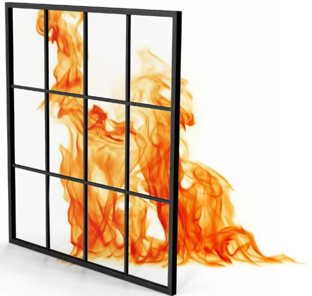
Le **vetrate fisse tagliafuoco a giunto siliconico** sono realizzate con un telaio portante in tubolare d'acciaio zincato, spessore 15/10, e rivestite con alluminio estruso in lega UNI 6060. All'interno, lastre isolanti in calcio-silicati offrono un'eccellente protezione termica. Possono essere realizzate in soluzione unica o con innesti per una facile movimentazione e installazione.
