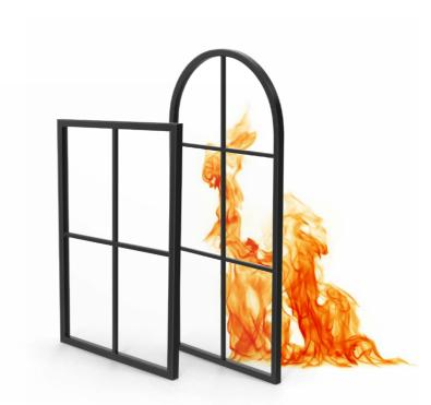
Le **vetrate fisse tagliafuoco ALU GLASS R7, R4, R4**, **R8** sono realizzate con profili in estruso di alluminio, in lega EN AW6060, opportunamente trafilati. Completati con guarnizioni fumi caldi autoespandenti perimetrali. All'interno, sono presenti lastre isolanti a base di calciosilicati che forniscono una protezione eccellente. La struttura ha uno spessore totale di 72 mm per i serramenti El<sub>2</sub>30/60 e 89 mm per i serramenti El<sub>2</sub>90/120.
