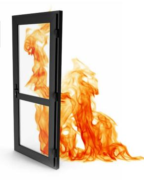
Le porte tagliafuoco ALU R1, R2, R6 e ALU VITREX F4 sono realizzate con profili in estruso di alluminio complanare, in lega EN AW6060, opportunamente trafilati. Completati con guarnizioni fumi caldi autoespandenti perimetrali. All'interno, sono presenti lastre isolanti a base di calciosilicati che forniscono protezione eccellente.
