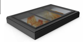
La **vetrata tagliafuoco VITREX F9 orizzontale** è realizzata con tubolare portante in acciaio ed è dotata di isolanti a base di silicati inorganici con guarnizioni termoespandenti lungo tutto il perimetro interno ed esterno. Il telaio, con uno spessore di 80 mm, presenta un peso di 60 kg/m². La struttura consente diverse configurazioni, anche con l'aggiunta di **traversi** per soddisfare specifiche esigenze progettuali.
