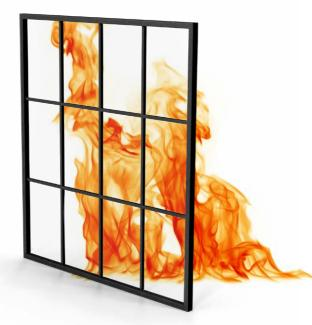
Le **vetrate fisse tagliafuoco a giunto siliconico** sono realizzate con un telaio portante in tubolare d'acciaio zincato, spessore 15/10, e rivestite con alluminio estruso in lega UNI 6060. All'interno, lastre isolanti in calcio-silicati offrono un'eccellente protezione termica. Possono essere realizzate in soluzione unica o con innesti per una facile movimentazione e installazione.
