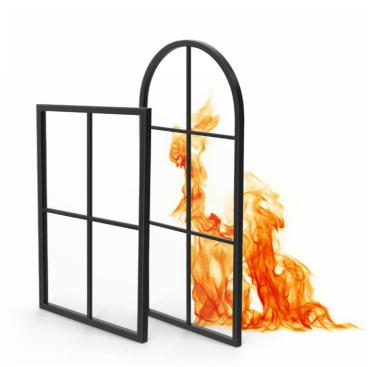
Le **vetrate fisse tagliafuoco VITREX F5 e VITREX F1.1** sono realizzate in tubolare d'acciaio profilato con alette di battuta. Sono dotate di lastre isolanti a base di calciosilicati e guarnizioni autoespandenti per fumi caldi perimetrali. La struttura ha uno spessore totale di 60 mm per i serramenti El<sub>2</sub>30/60 e 80 mm per i serramenti El<sub>2</sub>90/120.
