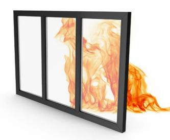
Le **vetrate fisse tagliafuoco VITREX F2 e VITREX F3** sono realizzate con un telaio portante in tubolare d'acciaio profilato zincato con uno spessore di 15/10, e sono rivestite da una copertura in estruso di alluminio trafilato in lega UNI 6060. All'interno, sono presenti lastre isolanti a base di calciosilicati che forniscono una protezione termica eccellente. La struttura ha uno spessore totale di 79 mm per i serramenti El<sub>2</sub>30/60 e 94/104 mm per i serramenti El<sub>2</sub>90/120.
