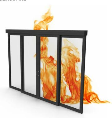
Le **porte scorrevoli tagliafuoco VITREX F13** sono realizzate con un telaio portante in tubolare d'acciaio profilato zincato con uno spessore di 15/10, e sono rivestite da una copertura in estruso di alluminio trafilato in lega UNI 6060. All'interno, sono presenti lastre isolanti a base di calciosilicati.
